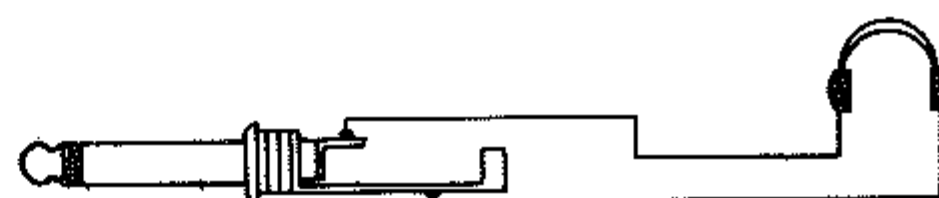
第4図 ヘッドフォンの接続方法
