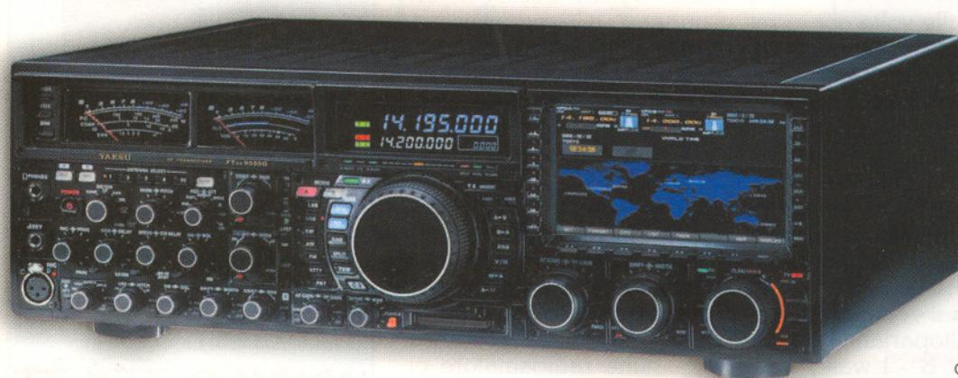
novazione che è rappresentata dal filtro "Roofing", filtro che segue immediatamente il primo mixer e che finora era standard o quasi con larghezza di banda di 15 kHz per cui misurare il livello di IP3 a banda stretta (5 kHz) era un rischio certo di ... brutti numeri. Qui i filtri Roofing sono tre, selezionabili, con passabanda di 15 kHz, poi di 6 kHz e infine di 3 kHz il che ha consentito un notevole miglioramento dell'IP3 a banda stretta.
