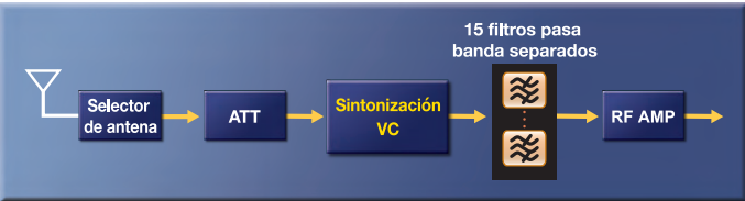
Terminal de RF de sintonización VC
