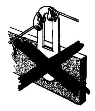
COLD SOLDER JOINT CONNECTION INSUFFICIENTLY HEATED
