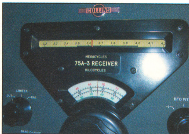
Fig. 5 - La scala di lettura della frequenza del 75A-3. L'albero di comando del PTO è connesso, con un giunto omocinetico, al disco di lettura dei kHz. La lettura dei MHz - indicati su un tamburo rotante mosso dal commutatore di banda - è ottenuta con un cursore trascinato a mezzo di funicella dall'albero di comando del PTO.
