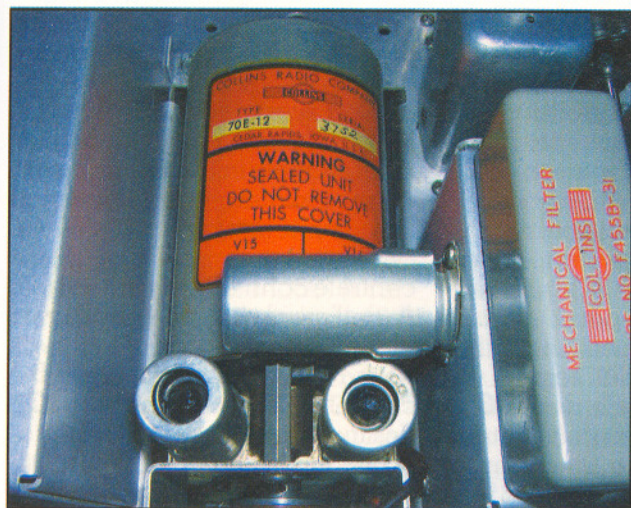
Fig. 4 - Il PTO tipo 70E-12 utilizzato nel ricevitore 75A-3. L'esemplare illustrato (serie N° 3752) è stato costruito nel 1953.
