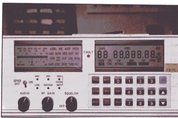
Foto 6 - HRRIS RT 1446 scala parlante del display in modo autotune/diagnosi
