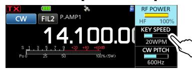
4. Drehen Sie **⊕MULTI**, um die Tastgeschwindigkeit auf einen Wert zwischen 6 und 48 Wörtern pro Minute (WPM) einzustellen.
