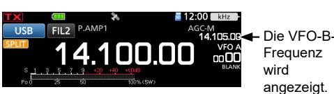
① Der Split-Frequenz-Betrieb ist einsatzbereit.
