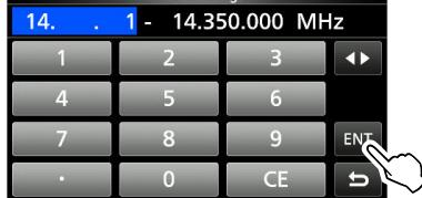
4. Bearbeiten Sie die Frequenz der oberen Bandkante und berühren Sie dann [ENT].
