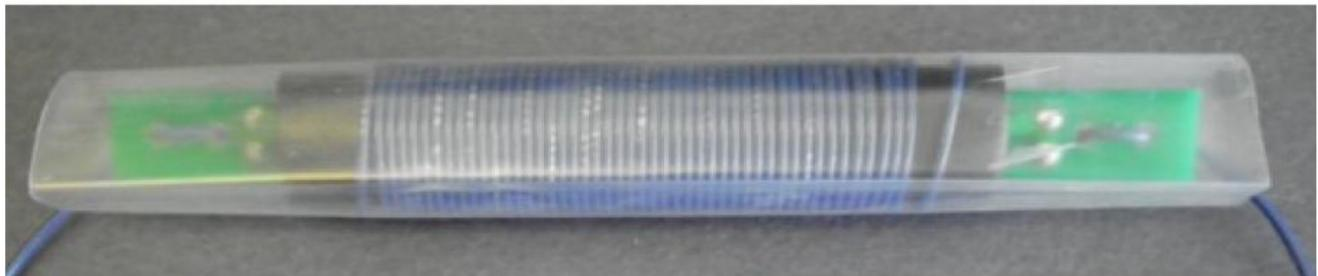
Refermer et rétrécir l'extrémité du tube à l'aide d'un pistolet thermique ou d'une autre source de chaleur. Soyez prudent pour éviter de surchauffer la forme de la bobine ou de causer des blessures.
