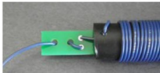
Tirez l'extrémité du fil pour enlever tout jeu et pour maintenir le fil en place sur le support PCB. Répétez ce processus à l'autre extrémité de la trappe avec le fil complémentaire et faites la même chose avec l'autre trappe.
