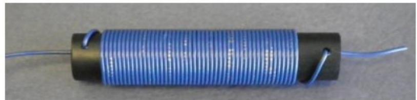
Enrouler les bobines en comptant un tour à chaque fois que le fil passe le point de départ. Gardez le fil aussi serré que possible et les spires bien jointes ensemble pendant l'enroulement.
