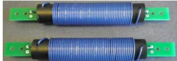
Insérez la carte de condensateur dans la bobine afin qu'elle soit centrée dans la forme, insérez aux extrémités de la bobine dénudée le fil dénudé dans le trou du PCB et souder les fils aux PCB. Répétez ce processus avec l'autre bobine pour compléter le jeu de trappes pour le dipôle.
