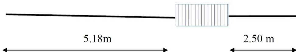
Les sections de 5.18 m seront la partie interne de l'antenne et les 2.50 m seront les extrémités extérieures de l'antenne.
