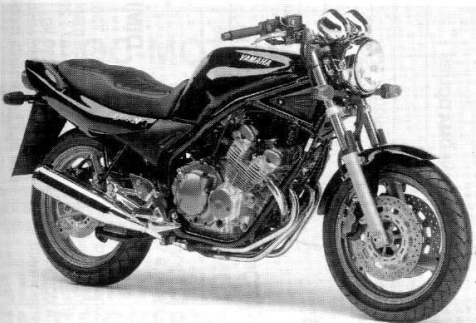
La série d'améliorations apparues en 1998 touchent également le modèle XJ 600 N (frein avant double disque, fourche renforcée, câblage électrique prévu pour le branchement d'une alarme).
