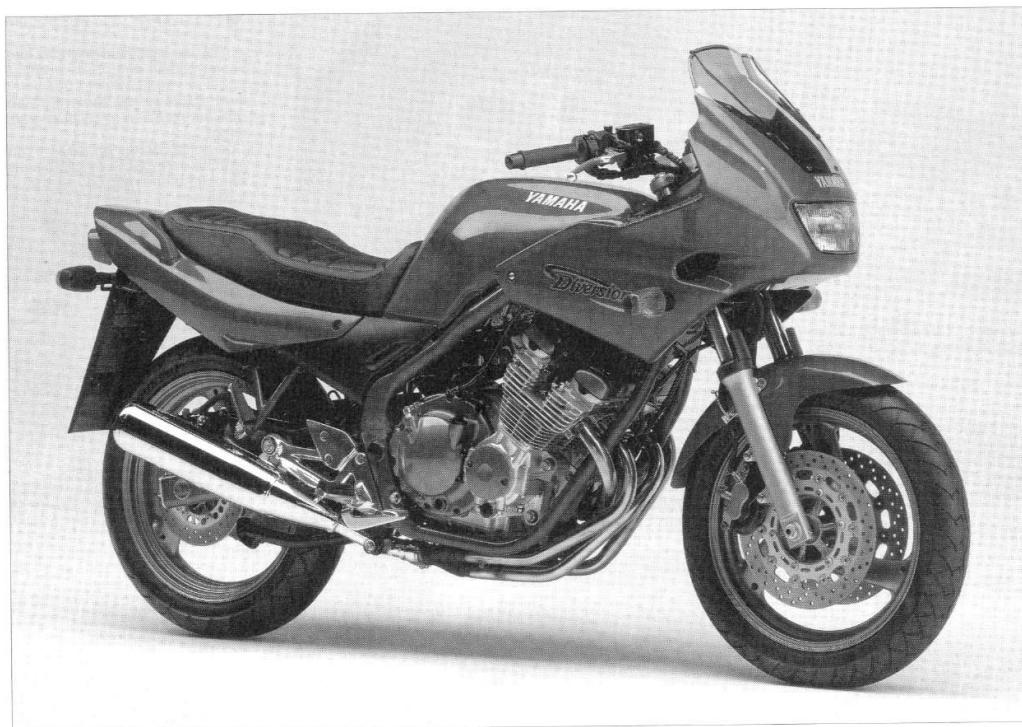
Au millésime 1998, la XJ 600 S Diversion bénéficie d'un frein avant à double disque ce qui a nécessité le montage de tubes de fourche plus rigides dont le diamètre passe de 38 à 41 mm.
