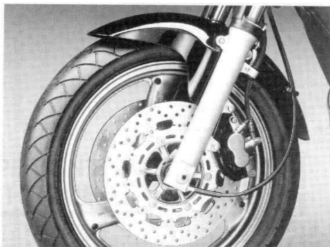
Frein avant double disque et fourche renforcée constituent les principales améliorations des modèles 1998.
