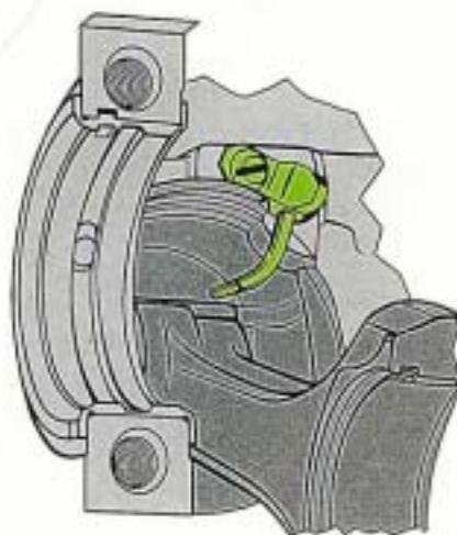
Die Ölspritzdüsen werden vom Hauptstromölkanal versorgt.
