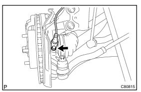
(d) Remove the bolt and speed sensor front LH.
