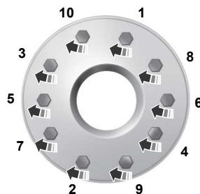
10-lug nut torque sequence
