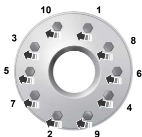
10-lug nut torque sequence
