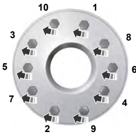
10-lug nut torque sequence
