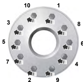
10-lug nut torque sequence
